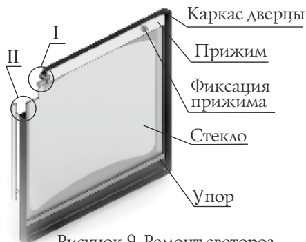
Рисунок 9. Ремонт светорозрачного экрана двери модели «Витра»
